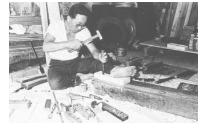
Der japanische Zimmermann oder Schreiner hält sein Werkstück vorzugsweise mit den Füßen fest, anstelle eines Werkzeugs wie Schraubstock oder Hobelbank zu verwenden.
