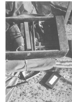
dogu-bako, die Werkzeugkiste, 1000mm x 300mm x 250mm, ist eine roh aus Brettern zusammen- genagelte Kiste, dem japanischen Schreiner ist es peinlich, mit einer wunderschönen Kiste durch die Straßen zu gehen
